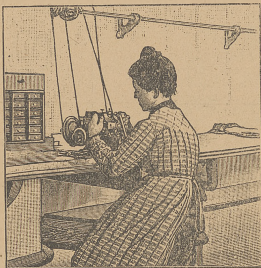
Fig. 5. Obecne osadzanie kółek za pomocą maszyny.
